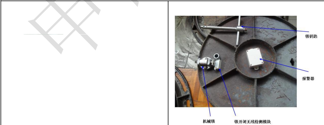
井盖位移传感器及无线模块
